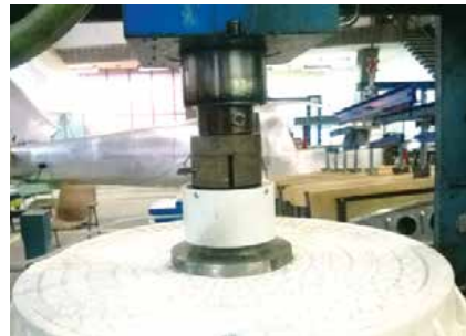
Испитивање и верификација композитног канализационог поклопца „kompotech kompozit tehnolojileri c/o 600mm“
