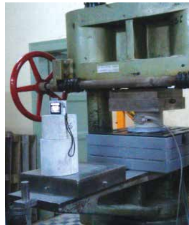
Испитивање и верификација сливничке решетке „mazgal 50*50*6 cercaveli“ Утврђивање функционалности и усаглашавање са безбедносним захтевима и испитивање чврстоће статичким оптерећењем према захтевима EN 124 D400
