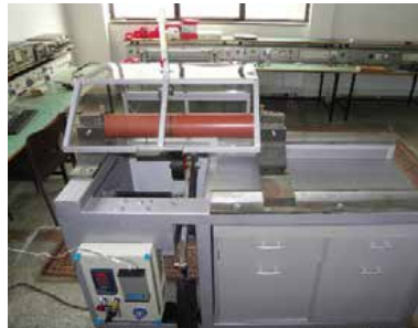
Пробни сто за испитивање момента отпора транспортних ваљака
