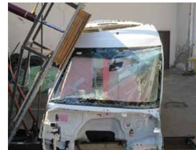
Слика 8. Испитивање структуре аутобуса према УН Правилнику бр. 66 (Лабораторија ЦИАХ)
