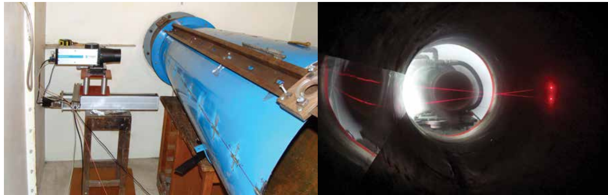
Истраживање турбулентног вихорног струјања у дифузорима - Примена ласер Доплер анеометарског система
