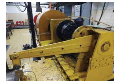
Слика 9. Пробни сто за испитивање кочница према УН Правилницима бр. 13 и 90 (ЛаБМВ)
