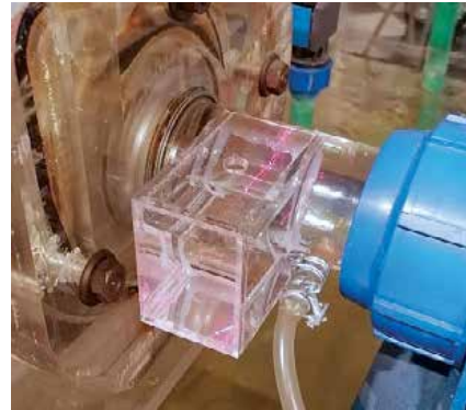
Инсталација за испитивање пумпи према стандарду ISO 9906 и истраживање феномена струјања у турбо пумпама са могућношћу даљинског управљања преко интернета
