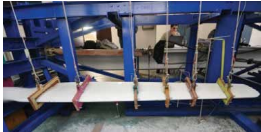
Статичко испитивање лопатице ветротурбине
