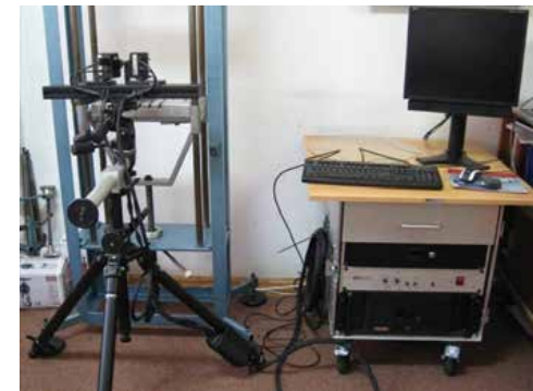
GOM систем за оптичко мерење статичке и динамичке деформације, ARAMIS.
