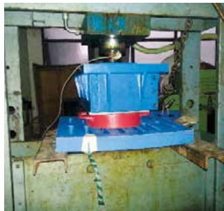
Испитивање и верификација сливничке решетке „kitya kompozit 60*60*6“
