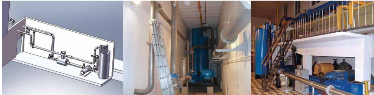
Постројење за испитивање хидрауличних пумпи, модела турбина, хидромашинске опреме и запреминских протокомера до 200 l/s
