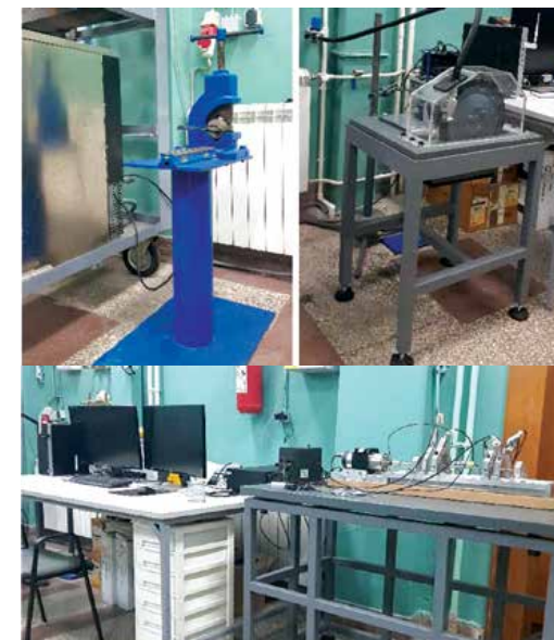
Слика 3 - Инсталације за вибродијагностику ротора, за мерење вибрација лопатица и инсталација са ваздушном турбином
