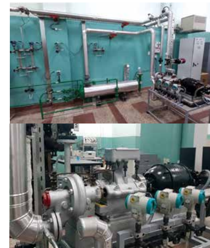
Слика 2 - Инсталација са парном турбином
