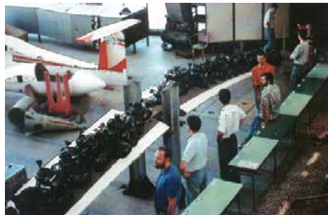
Ванредни прегледи и испитивања крила лаких летелица од композитних материла - Поступак испитивања крила у лабораторији на пробном столу до максимално дозвољеног оптерећења, при чему се контролишу и угиби.
