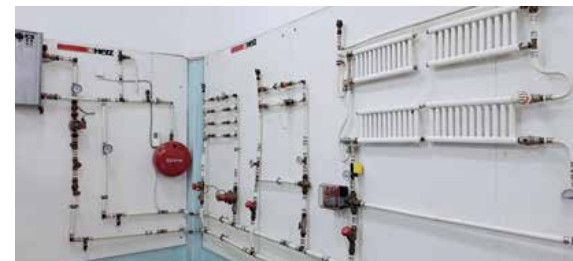
Зидна инсталација централног грејања у Лабораторији за термотехнику
