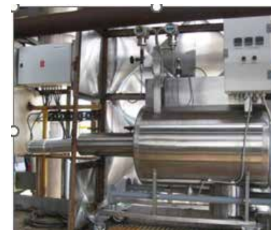
Уређај за мерење влажности паре развијен у Лаб. за генераторе паре и нуклеарне реакторе
