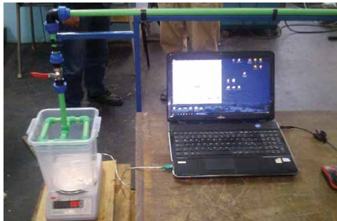
Калибрационо постројење за протокомере до 10 l/min
