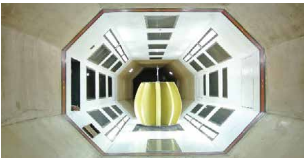
Испитивање тихих турбина са вертикалном осом (Silent vertical axis wind turbine - VAWT)
