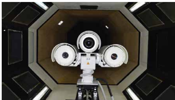
Испитивање утицаја ветра на оптоелектронски систем од композитног материјала
