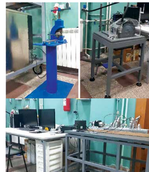
Слика 3 - Инсталације за вибродиагностику ротора, за мерење вибрација лопатица и инсталација са ваздушном турбином
