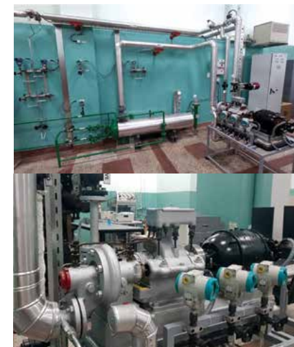
Слика 2 - Инсталација са парном турбином
