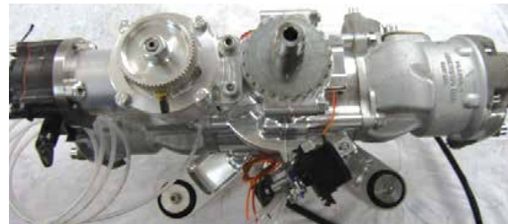
Мотор лаке беспилотне летелице снаге 54ks Реконструисање постојећег мотора (~ 30 ks, 26 kg). Након реконструкције (>50 ks, ~ 20kg)
