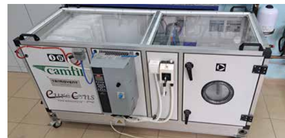
Клима комора за испитивање ефикасности филтера (горња) и клима комора за ваздушно грејање која користи отпадну топлоту кондензације расхладног постројења (доња)
