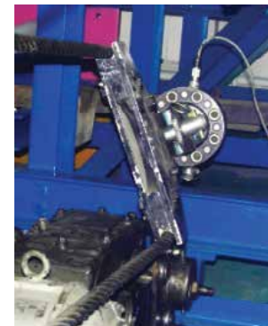
Испитивање на замор прострељане композитне лопатице репног ротора хеликоптера Ми – 8 Испитивање на замор прострељане композитне лопатице репног ротора хеликоптера Ми-8 је завршно тестирање у процесу испитивања, пројектовања, развоја технологије и израде репне лопатице.
