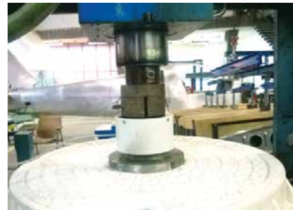
Испитивање и верификација композитног канализационог поклопца „kompotech kompozit tehnologijeri c/o 600mm“
