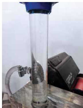
Инсталација за испитивање пумпи према стандарду ISO 9906 и истраживање феномена струјања у турбо пумпама са могућношћу даљинског управљања преко интернета
