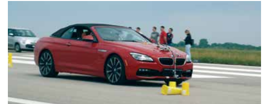
Слика 6. Возило BMW 650i, донација компаније BMW, које се користи као учило (на овој фотографији опремљен мерним уређајима за праћење динамичког понашања у току вожње на полигону)
