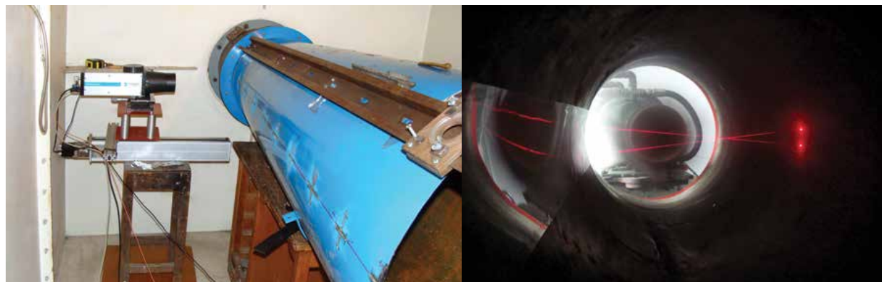
Истраживање турбулентног вихорног струјања у дифузорима - Примена ласер Доплер анемометарског система
