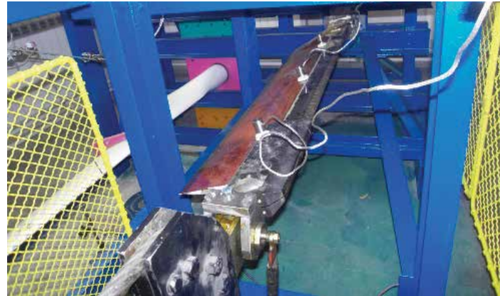
Фрекфентна анализа лопатице репног ротора хеликоптера Ми-8
