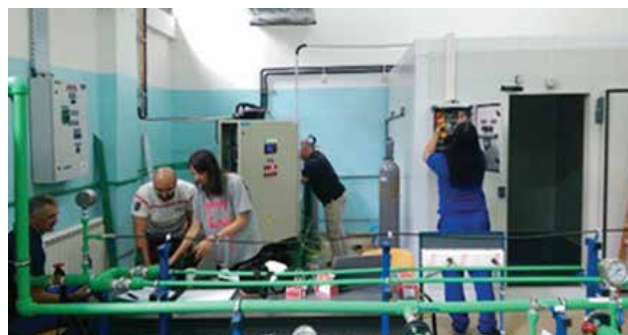
Испитна расхладна комора са каскадним расхладним агрегатом (у позадини) и пумпно постројење (испред) у Лабораторији за термотехнику
